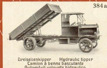
Dreiseitenkipper / Hydraulic tipper / Camion à benne basculante / Automóvil volquete hidraulico 384a
