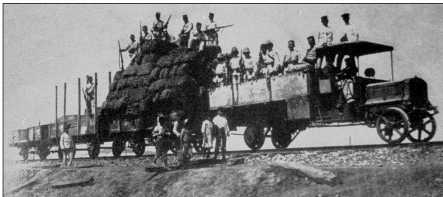
Einsatz eines Benz-Lkw als Schienenfahrzeug 1915
