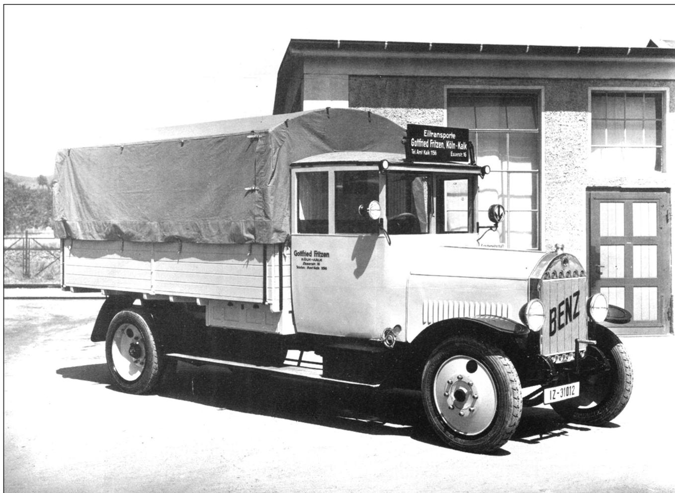
Luftbereift und mit vollständig geschlossenem Fahrerhaus erschien der 1,5-Tonner 1 CN 1925
