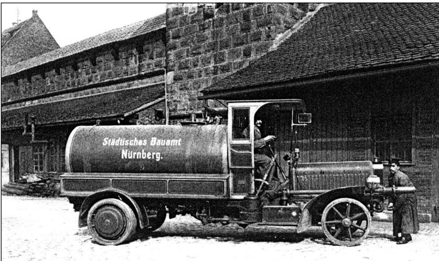
Braun-Premier 5-t-Typ G.O.H.E.25 mit benzin-elektrischem Antrieb 1911
