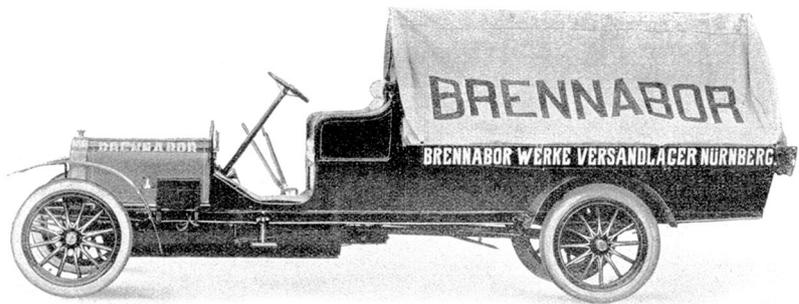
6-8 PS, 2 Zylinder, für Nutzlasten bis 300 kg    •••    12-14 PS, 4 Zylinder, für Nutzlasten bis 600 kg
