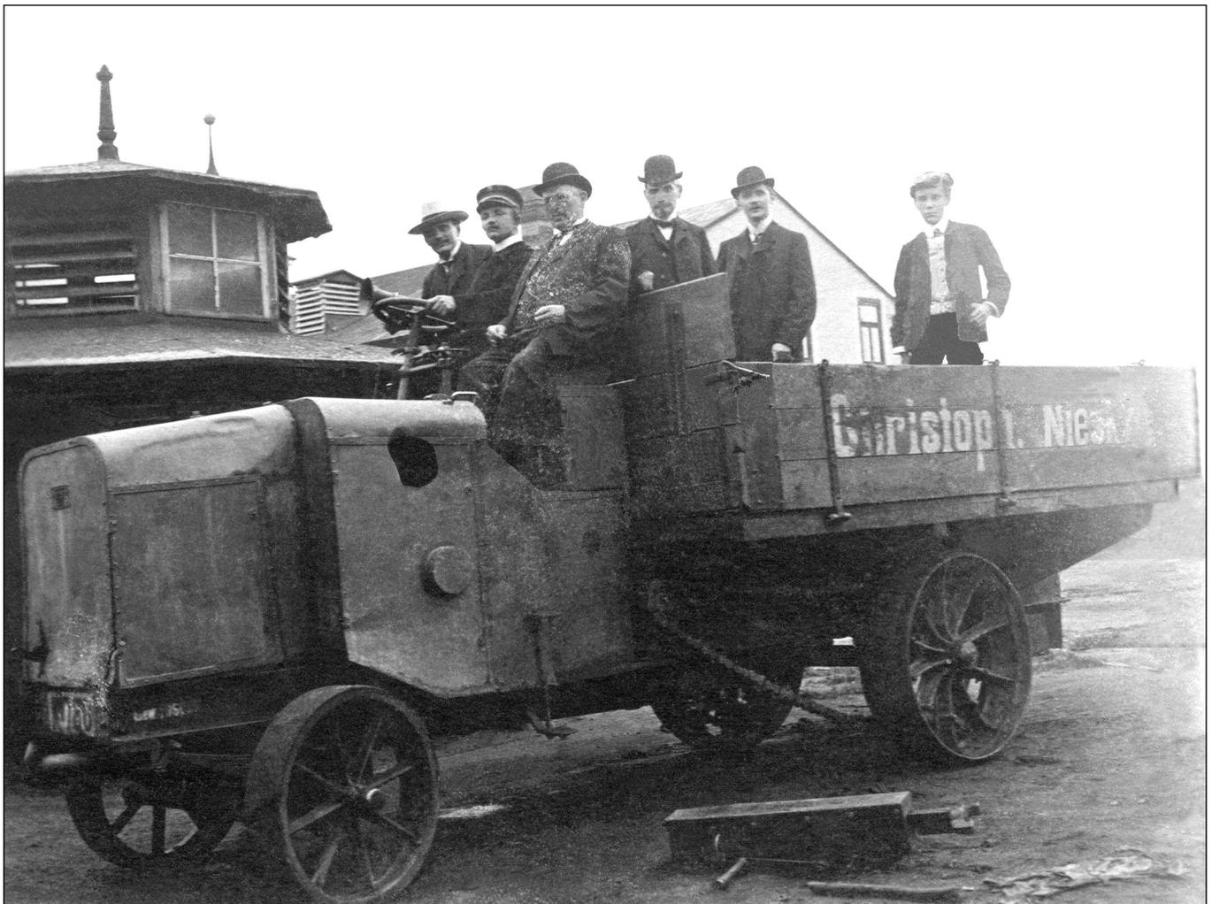
Versuchsfahrzeug der Maschinenfabrik J. E. Christoph, Act.-Ges., aus dem Jahr 1906 mit liegendem Einzylindermotor <sup>20</sup>
