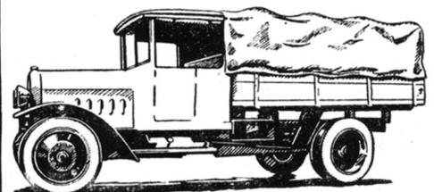
Luftbereifter Schnell-Lastkraftwagen, 2½ bis 3 Tonnen
