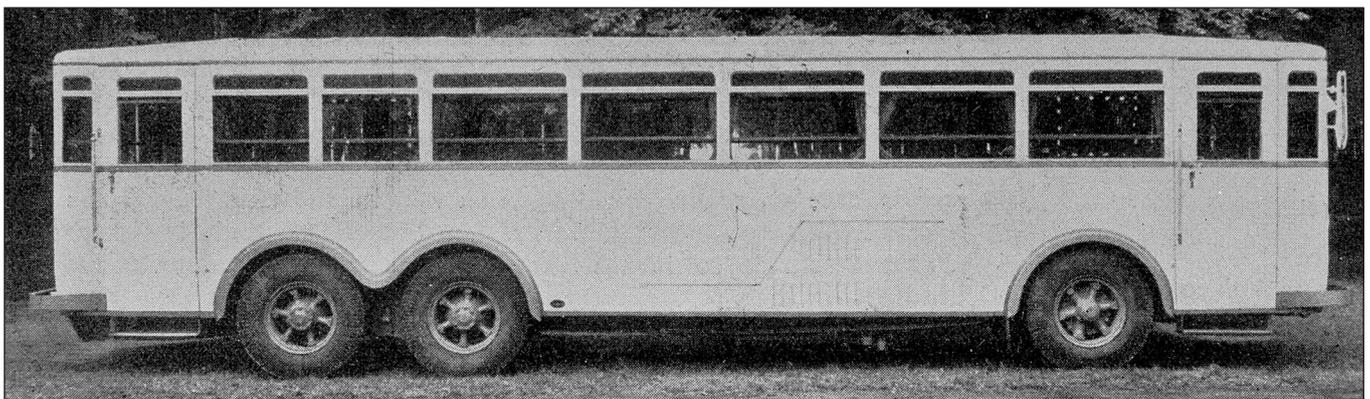
Die HAWA entwickelte 1930 mit Büssing einen rahmenlosen Frontlenker-Omnibus, der „Trambus“ genannt wurde <sup>1</sup>
