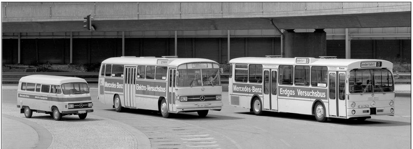
MB 1971 Elektro-Versuchsbus LE 306 – MB 1969: Elektro-Versuchsbus OE 302 – MB 1971 OG 305 Erdgas
