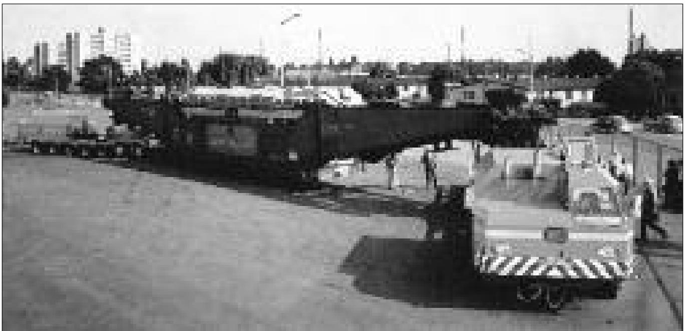
Der 1973 vorgestellte Scheuerle-Plattformwagen mit zwei Triebköpfen (2930 PS) im Einsatz für die Deutsche Bundesbahn
