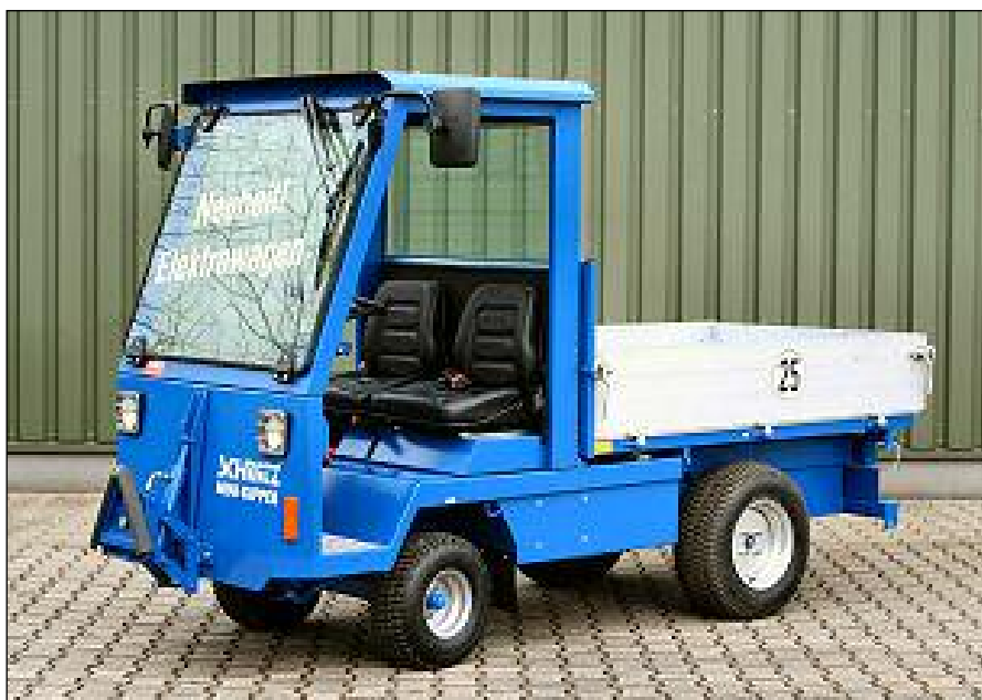
Schmitz-Minikipper Typ MK 1700 E mit Elektroantrieb
