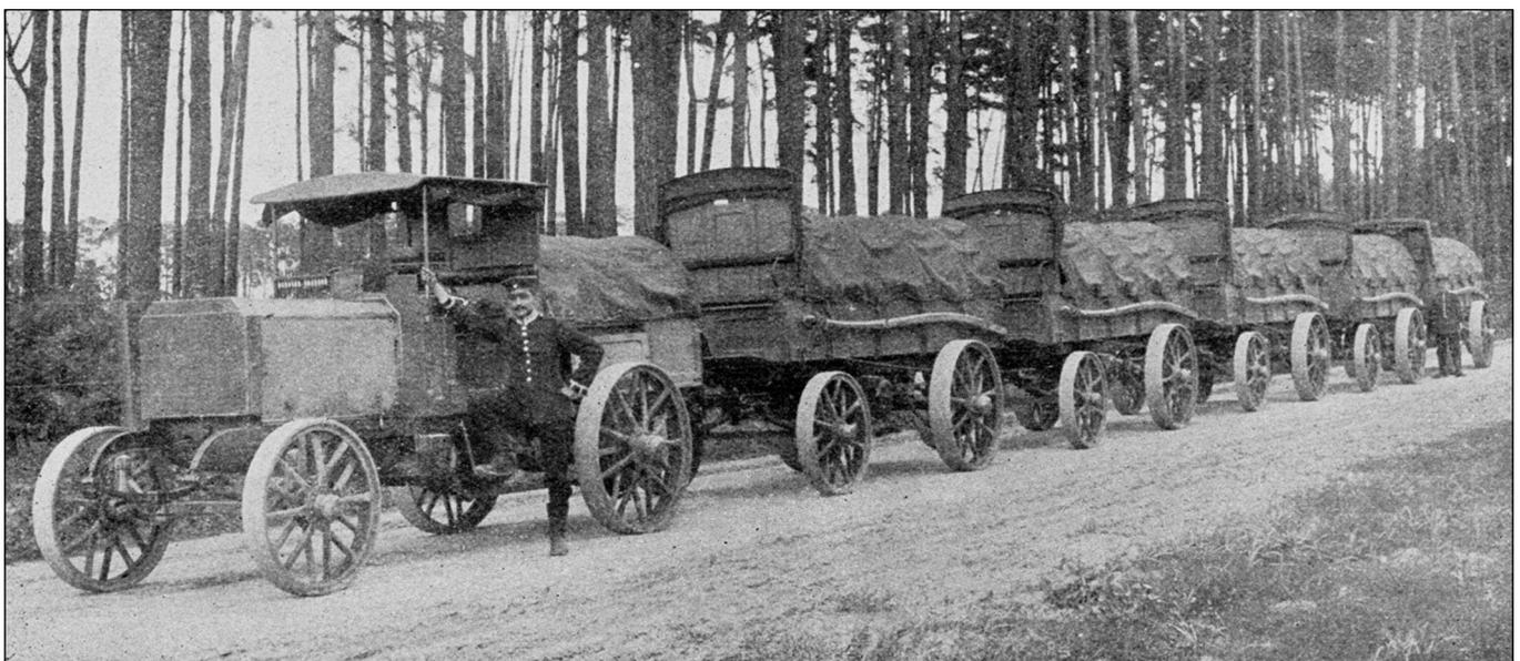
Benzin-elektrischer Straßenzug mit elektrischem Antrieb der Anhänger
