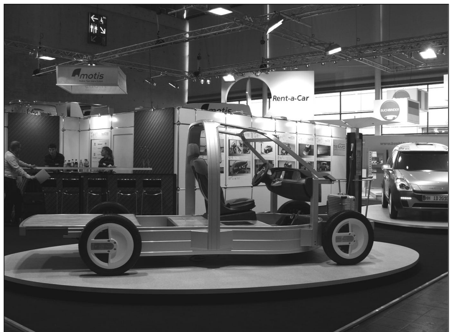
Das Spaceframe-Sicherheits-Chassis des Teamo e-cargo-vans auf der IAA 2008 1
