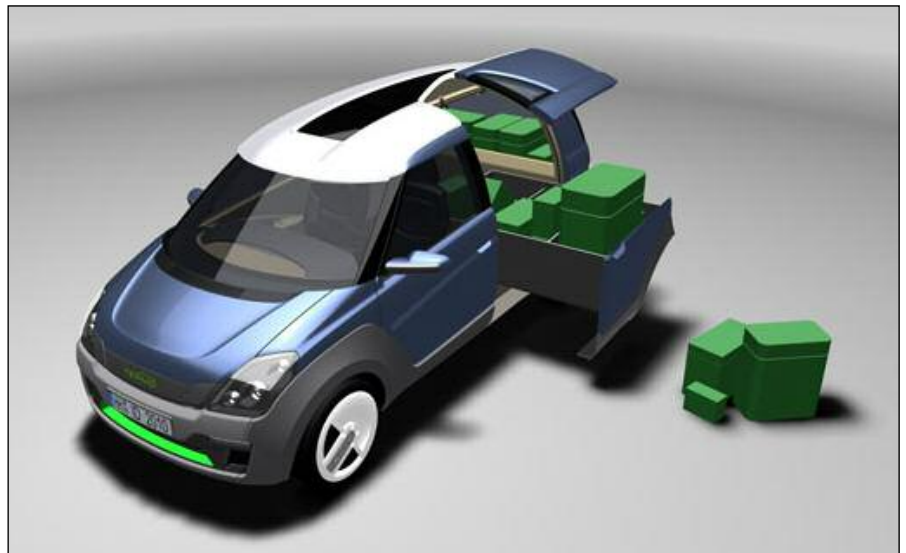
Der Teamo e-cargo-van mit leicht zugänglichem, seitlich ausgezogenem Ladeboden Teamo
