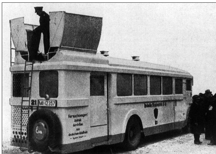
Versuchsbus der Waggonfabrik Wismar 1933 mit Imbert-Holzgasgenerator
